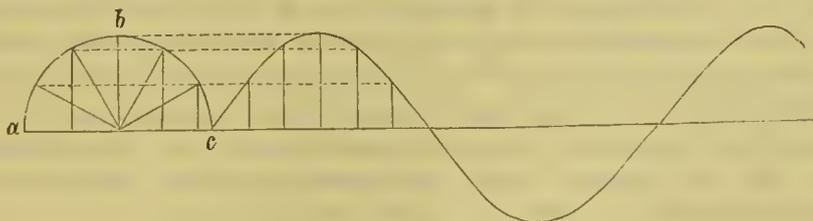
eine Hälfte des abzurollenden Kreises. Die Peripherie ist in gleiche Stücke getheilt und auf der Abscissenaxe abgetragen. Die Ordinaten sind dem Sinus der zugehörigen Bogen, multipliziert mit dem Halbmesser, gleich gemacht. Würde ich die Zahlen für die Sinus nicht mit dem Halbmesser des abgerollten Kreises, sondern mit irgend einer kleineren Grösse multipliziert
